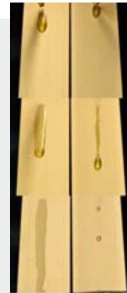
SuSoS lässt sich von der Lotusblume inspirieren, verwendet jedoch eine andere Methode, um Öl- und Wasser-abweisende Eigenschaften zu erzeugen: Sich selbst organisierende, fluorierte Moleküle, die zusammen eine Oberflächenbeschichtung bilden, sowohl auf glatten (Bild links) als auch komplexen Bauteilen wie Gittern (Bild rechts unten)
