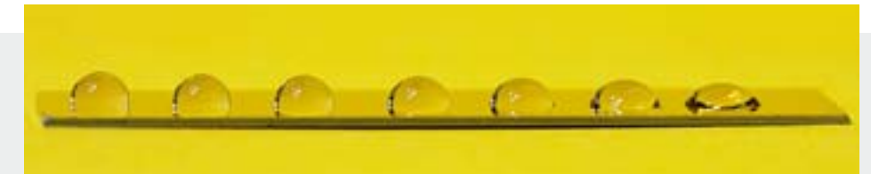
Das Bild oben zeigt, wie exakt sich die Benetzungseigenschaften von hydrophob zu hydrophil einstellen lassen – ein wesentlicher Faktor beim Verbinden unterschiedlicher Materialien. Die SuSoS AG kombiniert dazu funktionelle Polymere mit ihren von der Muschel abgeleiteten Klebstoffen
